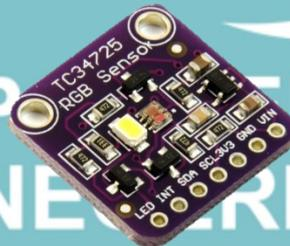
Gambar 2.11 Sensor Warna TCS34725
