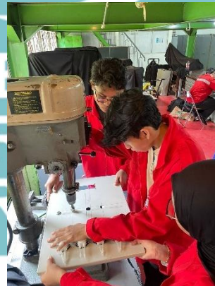
Lampiran 1. 4 Pembolongan pintu panel untuk komponen
