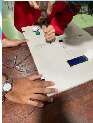
Lampiran 1. 3 Proses penempatan komponen pada pintu panel
