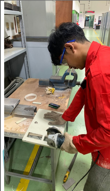
Dokumentasi pemotongan pintu panel untuk LCD I2C
