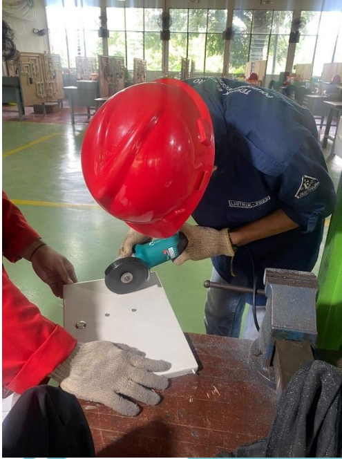
Dokumentasi pada saat menggerindra bos panel
