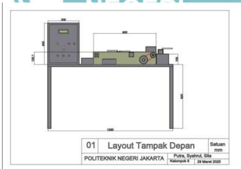
Gambar 3. 11 Gambar Desain seluruh alat
