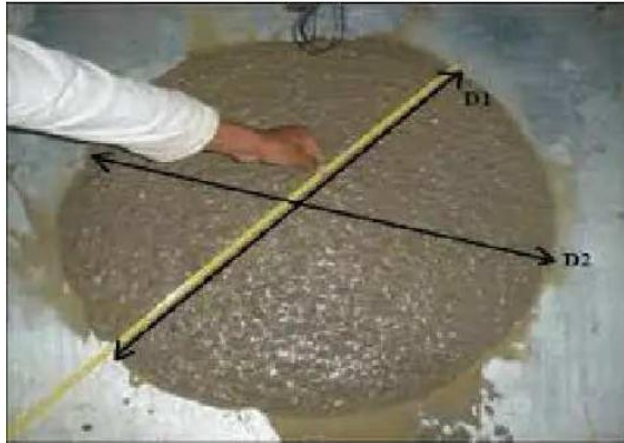
Gambar 2.4 Cara Pengukuran Sebaran Beton
