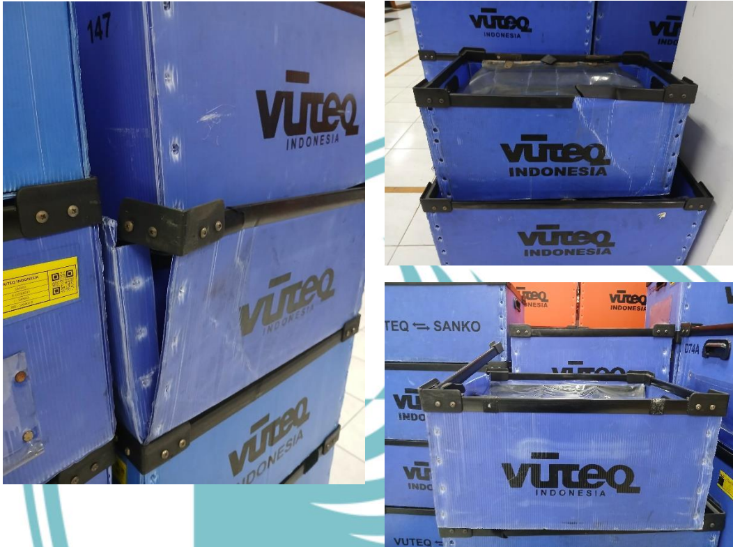
Lampiran 3 Kondisi Box Barang Jadi Rusak Karena Tidak Terawat
