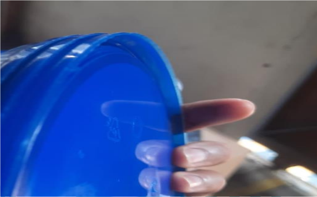
Lampiran 6. Cacat Flow Pada Bucket IML
