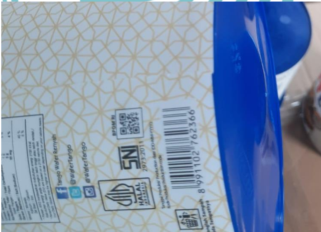
Lampiran 4. Cacat Label Miring Pada Bucket IML
