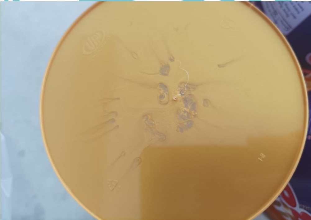
Lampiran 6. Cacat Flow Pada Bucket IML
