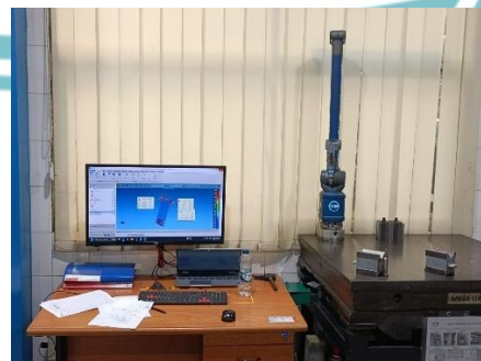
Inspeksi menggunakan FARO
