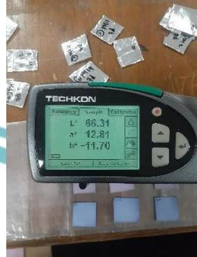
Proses Pengukuran Nilai  $L^*$   $a^*$   $b^*$  Menggunakan Spectrodensitometer
