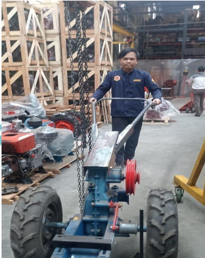
Lampiran 4 Hasil desain handle traktor setelah difabrikasi ‘
