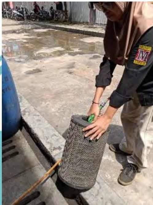
Gambar 1 Pembersihan Filter Udara
