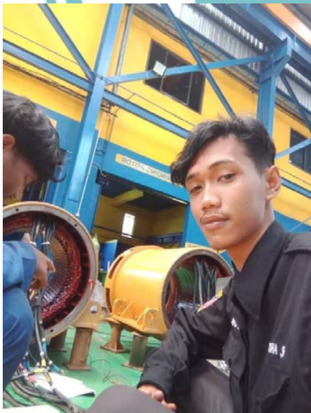
Proses rdc test pada stator generator
