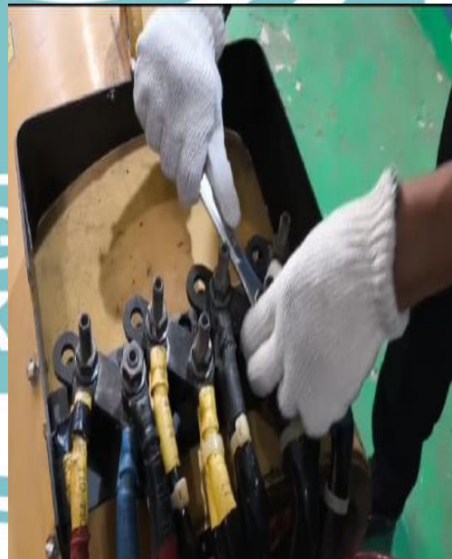
Proses pelepasan terminal
