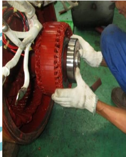
Proses pemasangan bering
