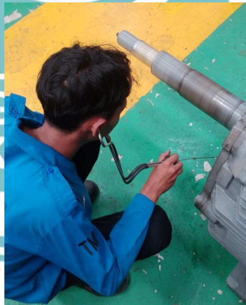
proses pemeriksaan bearing pada motor 3 phase
