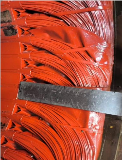
Proses pengukuran panjang gulungan
