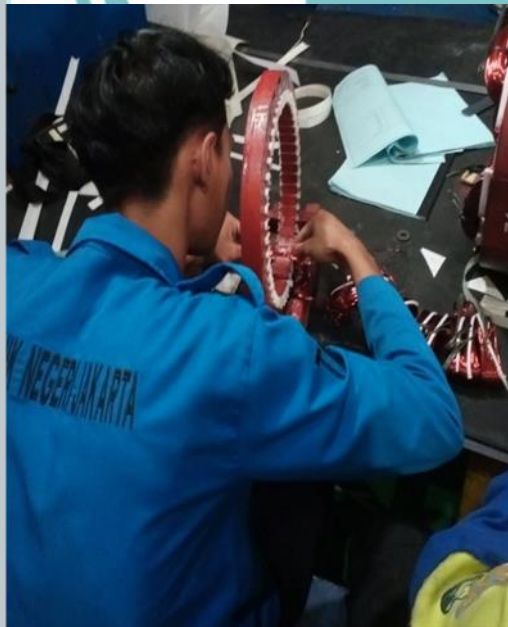
proses penggulangan exciter PMG
