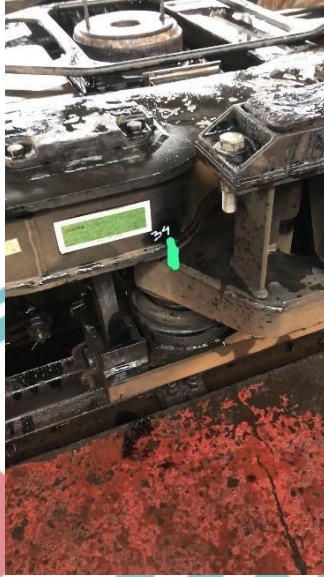
(Mengukur jarak balok air ke frame kereta)
