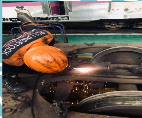
(Proses pengelasan pengaman triangle untuk memperbaikinya)
