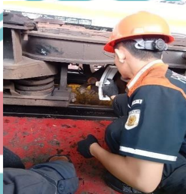
(Proses marking pada block rem)
