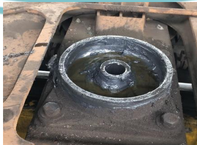
(Pelumasan dan penambahan grease block center sebelum terpasangnya senter plat)
