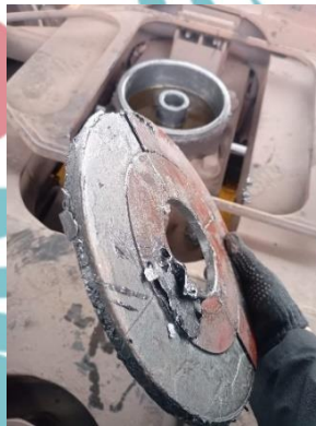
(Contoh kerusakan pada center plat yang mengalami kerusakan atau patah pada sisinya)
