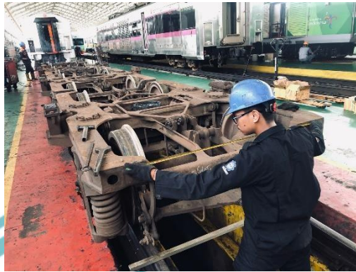
(Proses pengukuran panjang sisi pada bogie)
