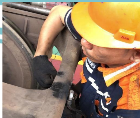
(Pengencangan mur pengaman triangle setelah pngelasan)
