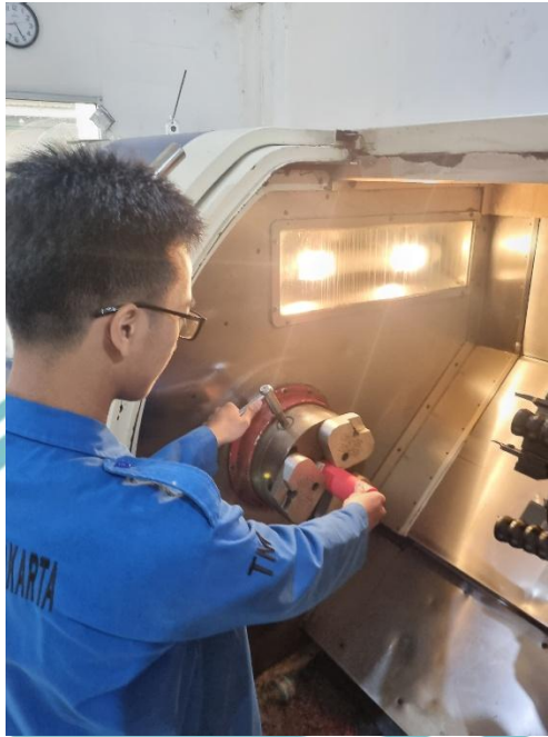
Pemasangan Material pada Mesin Bubut CNC
