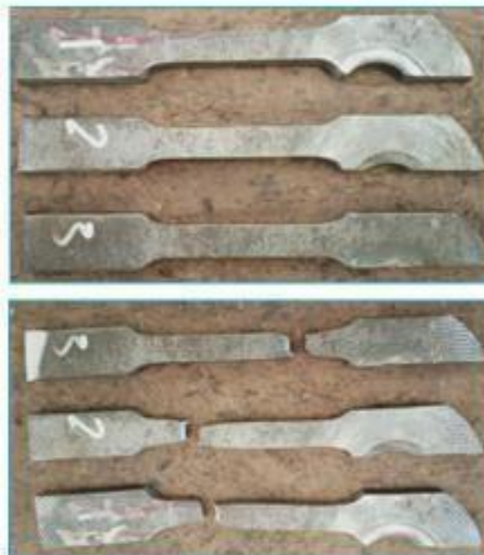
Gambar 3. Sample Uji Tarik Chain Link RE1 Temperatur Kamar Sebelum Uji Tarik dan Sesudah Uji Tarik
