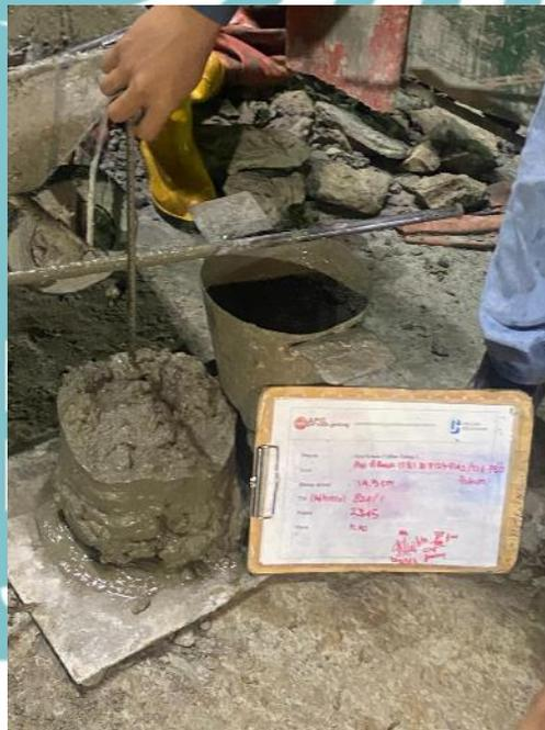
Gambar 4.39 Uji Slump
