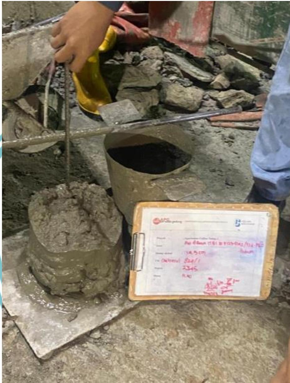
Gambar 4.45 Hasil Uji Slump
