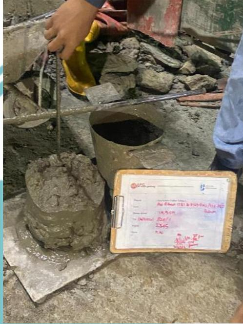
Gambar 4.21 Dokumentasi Pengujian Slump
