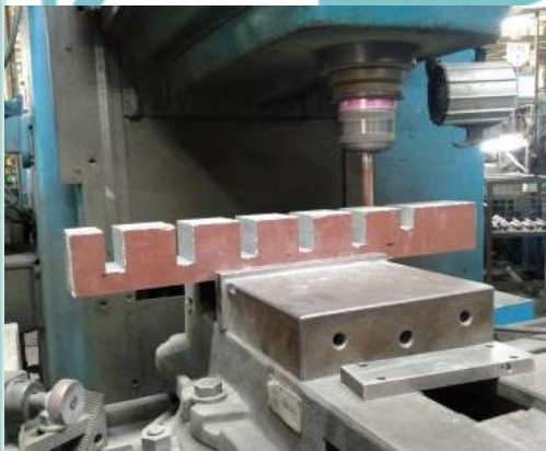
Proses Machining Jig di Bak Air
