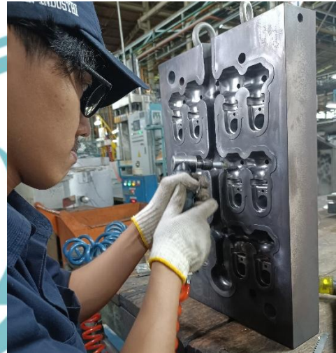
Menghaluskan permukaan cavity Menggunakan alat wire brush
