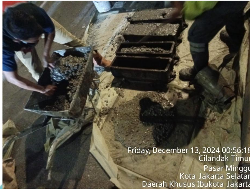
Gambar 3. 64 Persiapan Sampel untuk Flexural Test
