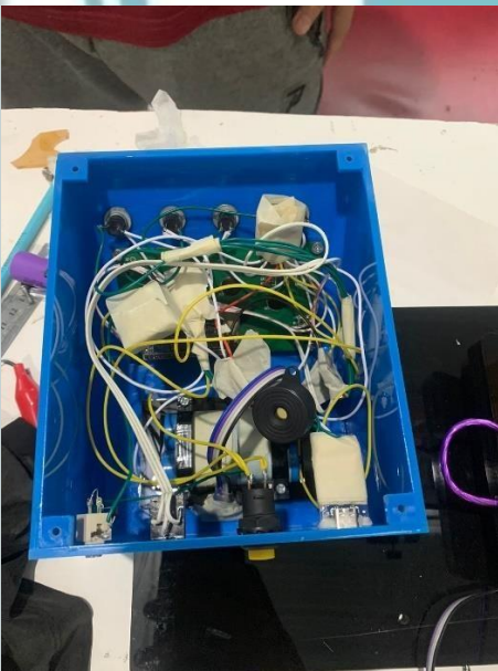
Lampiran 4. Wiring Pada Alat Ukur Viskometer
