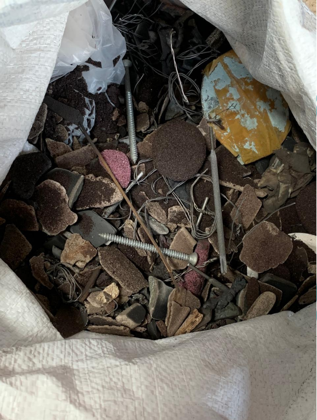
Lampiran 4. Kotoran atau Material Asing yang dikeluarkan saat membersihkan screen deck atau screen mesh.
