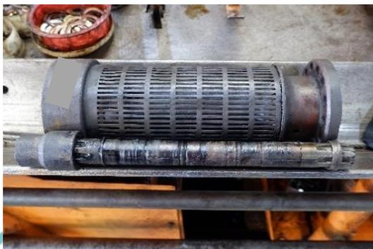
Gambar 3.4.2 Bushings dan Sleeves pada Bagian Komponen Intake/ Gas Separator
