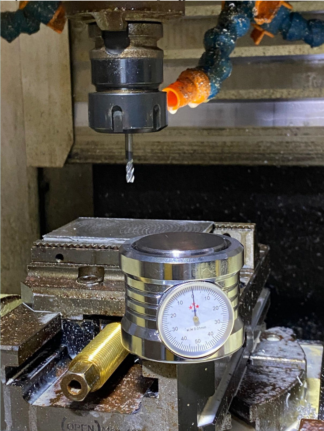
Lampiran 8. Dokumentasi Proses Zero Centering Menggunakan Zero Setter
