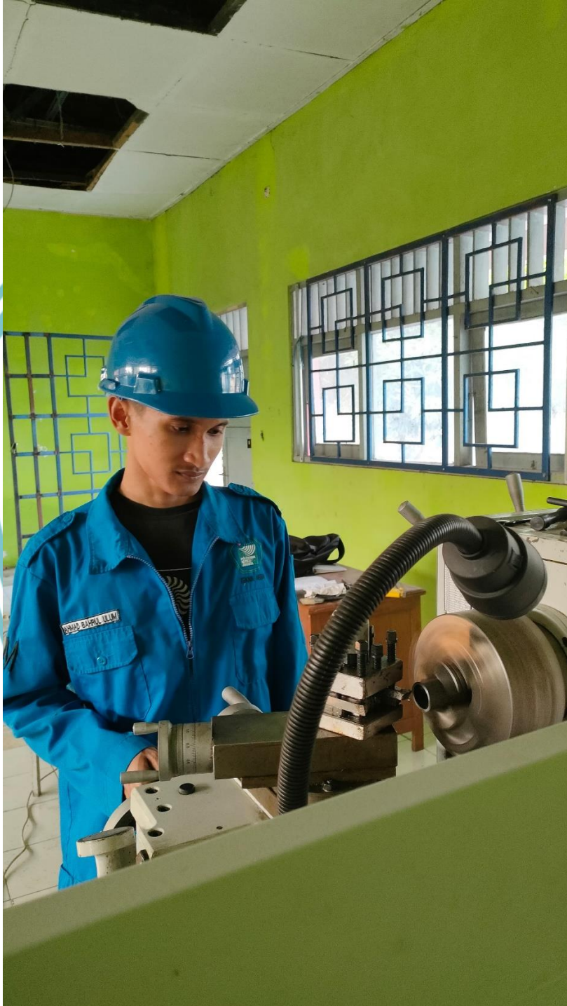
Lampiran. 5 Pembubutan komponen alat pembersih Pantai
