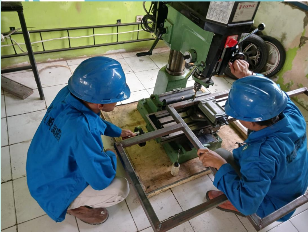
Lampiran. 4 Pengeboran rangka alat pembersih pantai
