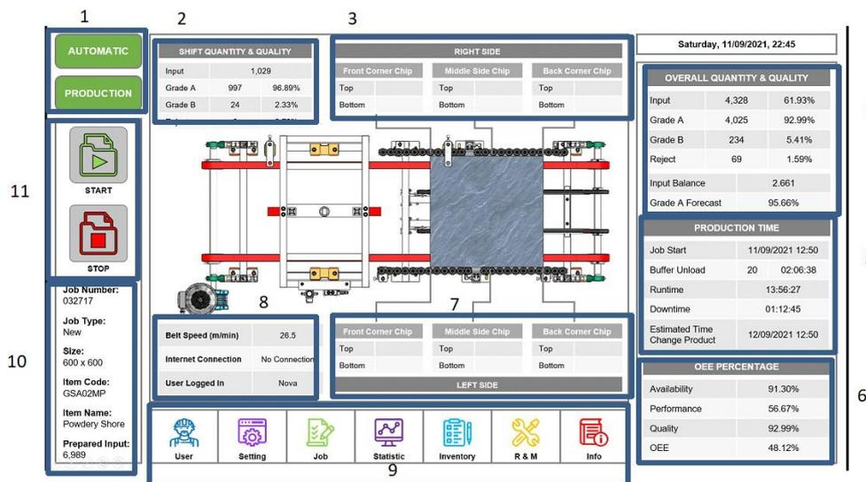
Gambar 3. Rencana dan Desain Sistem Pemonitor dalam HMI
