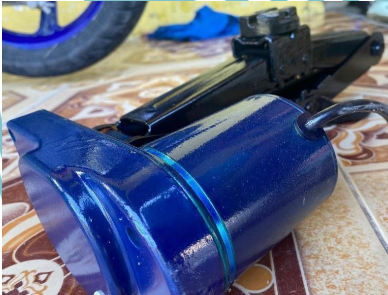
Lampiran 2. Dongkrak Ulir Yang Sudah Dimodifikasi Menjadi Dongkrak Elektrik
