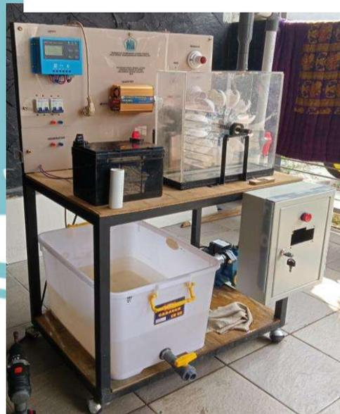
**Gambar 4.1** Hasil Akhir Trainer Kit Pembangkit Listrik Tenaga hydro Menggunakan Turbin Pelton
