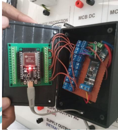
Gambar 3. 5 Penempatan ESP32 dan komponen lain
