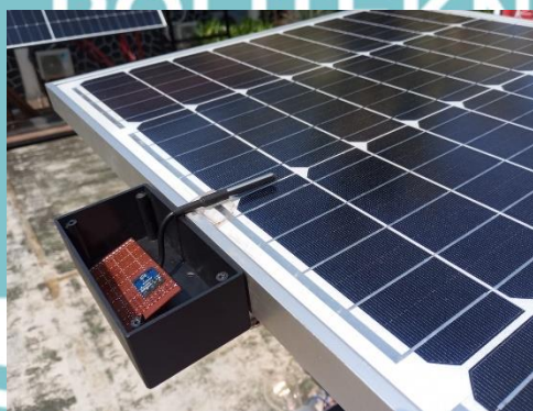
Gambar 3. 4 Penempatan sensor suhu dan itensitas cahaya
