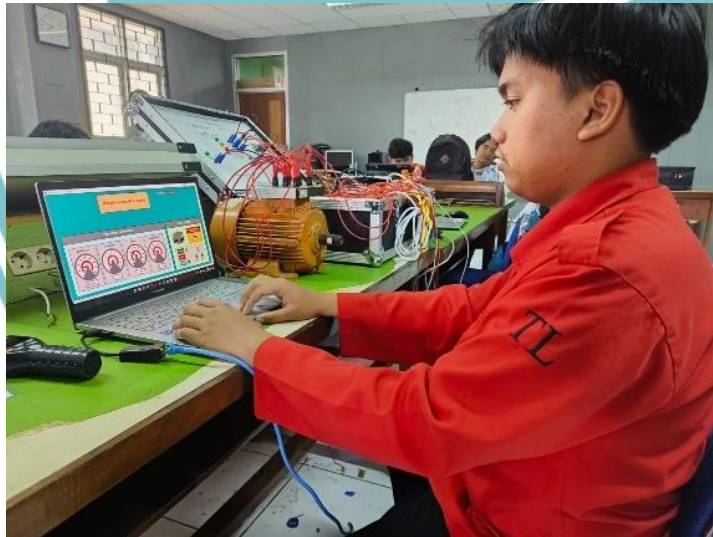
Proses pengujian komunikasi PLC, HMI, VSD, SCADA.
