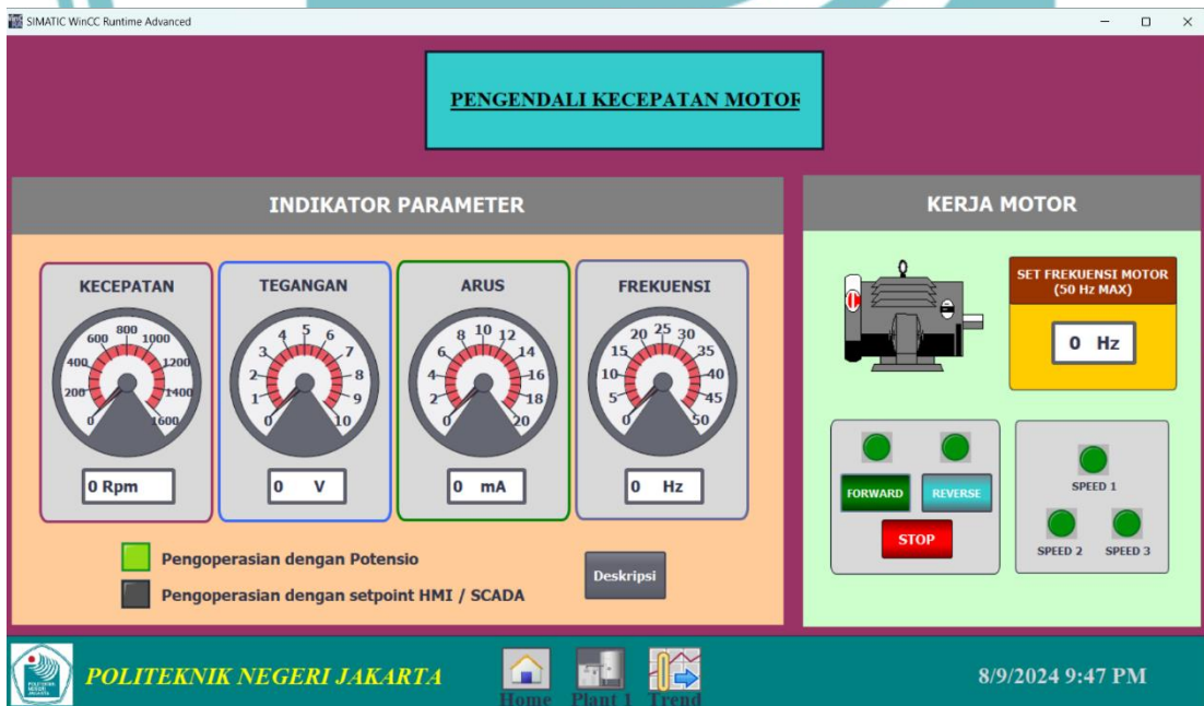
Desain SCADA Pengendalian Kecepatan Motor Induksi.
