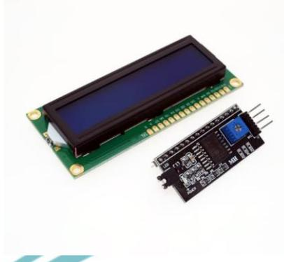
Gambar 2. 8 LCD dengan I2C
