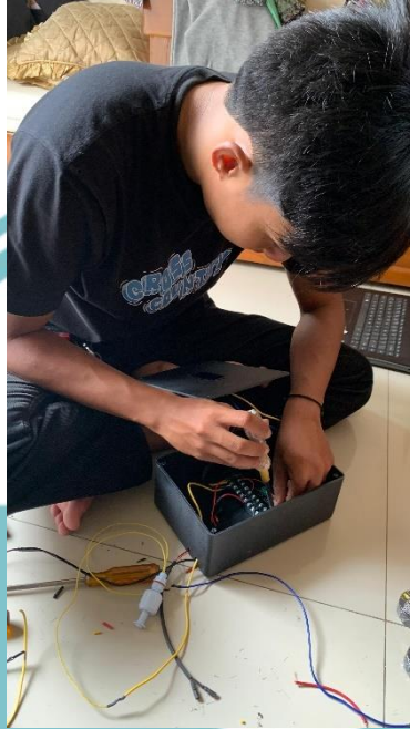
Lampiran 1. Proses wiring pada komponen box.
