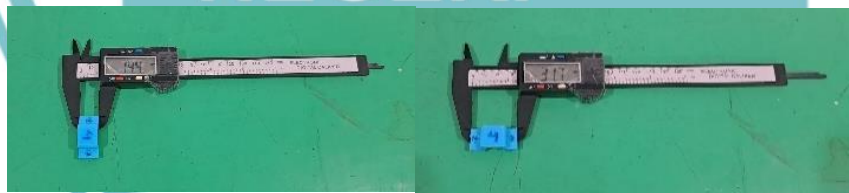
Gambar L.6 Pengukuran Objek 3D Level 4 menggunakan Jangka Sorong
