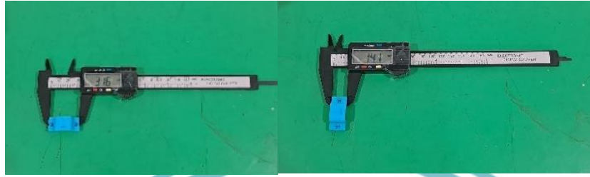
Gambar L.3 Pengukuran Objek 3D Level 1 menggunakan Jangka Sorong
