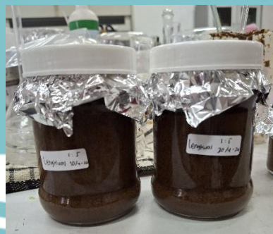
Gambar 4. 2 Maserasi Bubuk Lengkuas Merah
