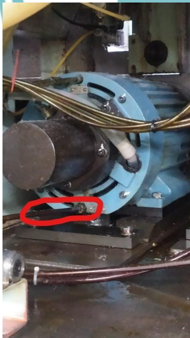
Lampiran 5 Gambar jalur oli pelumas yang terhambat gel
