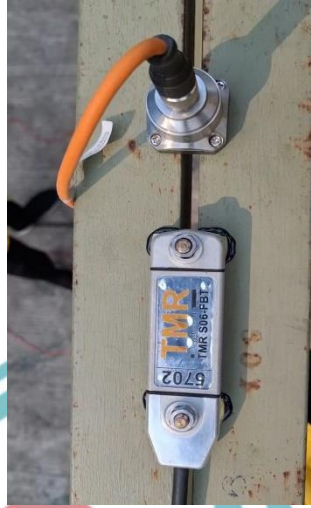
L-3. 5 Pemasangan accelerometer dan strain gauge
