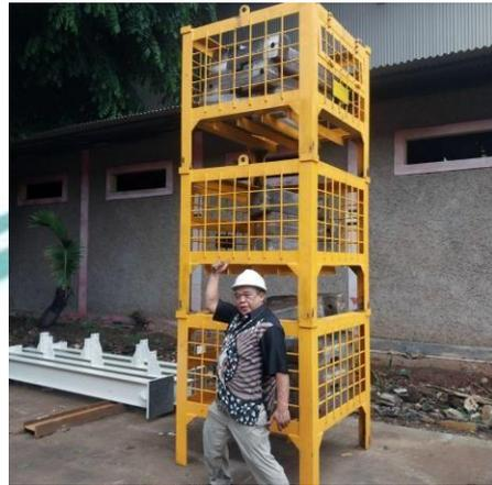
Pengujian *mesh pallet box* bertumpuk menggunakan material casting.
