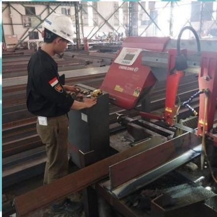
Proses pemotongan material menggunakan mesin *bandsaw*.
