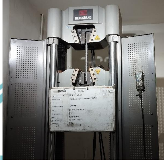
Gambar 3. 68 Pengujian Tarik Tulangan Sumber : Dokumen Pribadi
