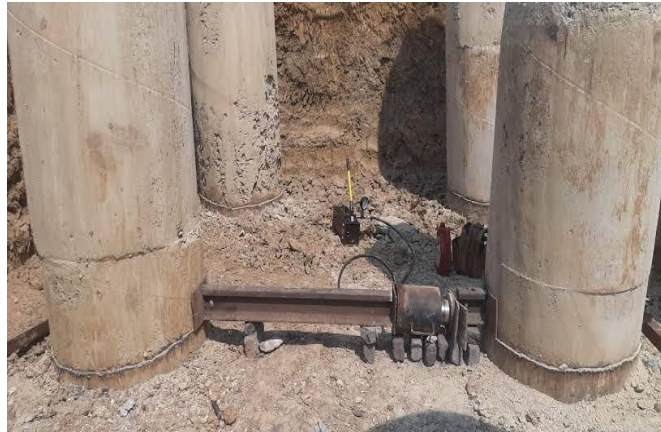
Gambar 3. 77 Pengujian Lateral Sumber : Ilustrasi
