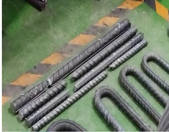
Gambar 3. 70 Hasil Pengujian Tulangan Sumber : Dokumen Pribadi
