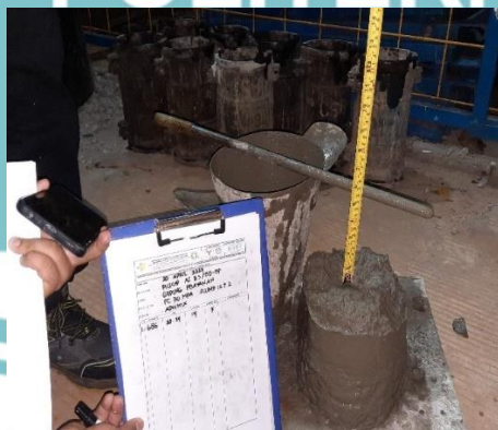
Gambar 3. 65 Uji Slump Beton Sumber : Dokumen Pribadi
