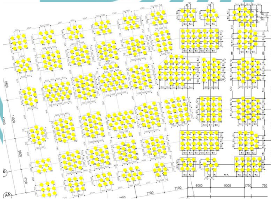
Gambar 3. 9 Mapping Pemancangan Gedung Pelayanan Sumber : Dokumen Pribadi
