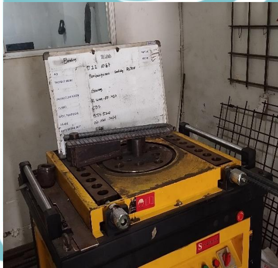
Gambar 3. 69 Pengujian Tekuk Tulangan Sumber : Dokumen Pribadi
