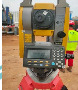
Gambar 3. 71 Marking Out Titik Pancang Sumber : Dokumen Pribadi
