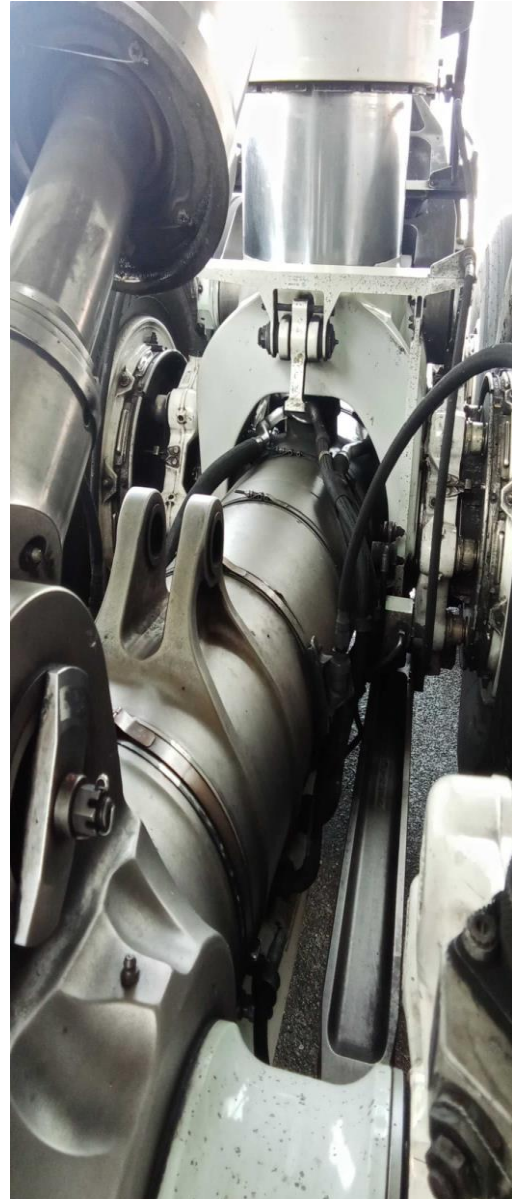
Gambar 4.2.1 Membersihkan Shock Strut dari kotoran yang menempel
