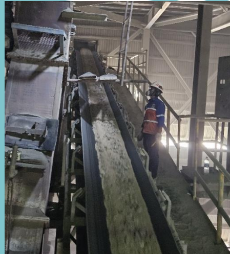
Gambar 3.44 Inspeksi Pada Belt Conveyor
