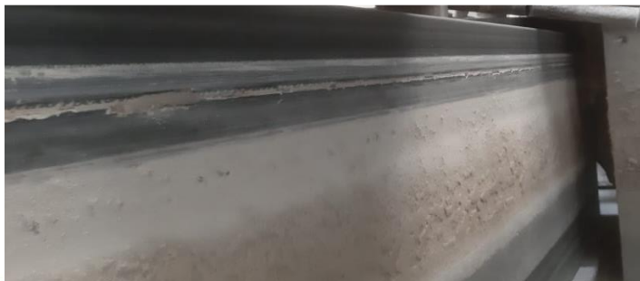
Gambar 3.39 Scratch Pada Top Cover Rubber Belt
