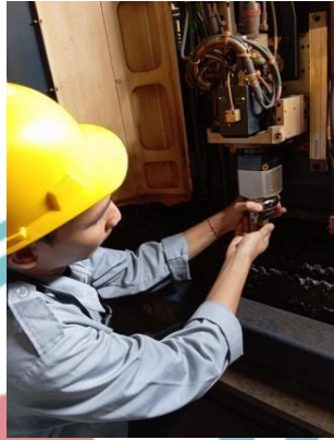
Gambar 3. 16 laser cutting head untuk mengambil lensa yang rusak
