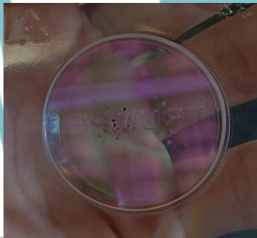
Kondisi Lensa Kotor / Rusak
