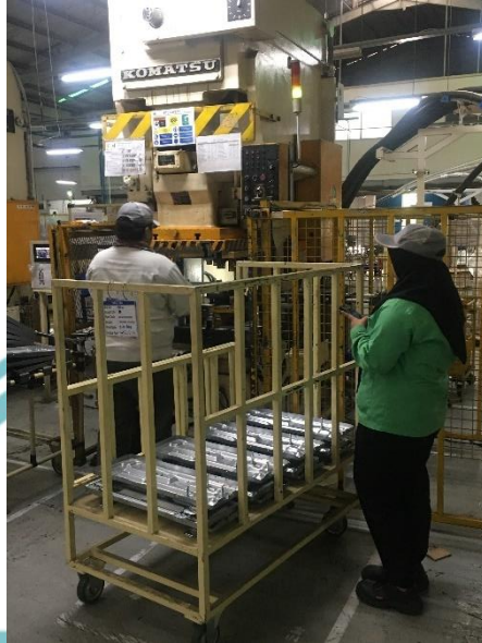
Proses pengambilan data cycle time pada mesin press Section 1 Manufacturing 1 (Press Shop)
