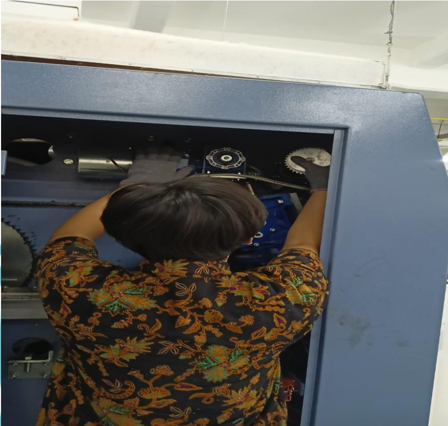
Penggantian sprocket gear mesin tranmastic GFO 1067
