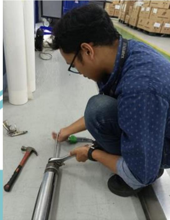
4. Melakukan *Repair Generator Ultrasonic Sewing*
