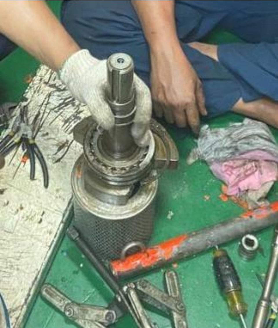
LAMPIRAN 11 Ditemukan Kerusakan pada Bearing
