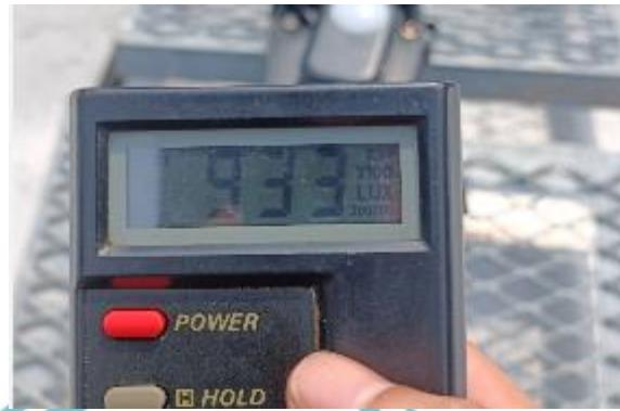
Didapatkan rata-rata hasil pengukuran *Global Horizontal Irradiation* (GHI) menggunakan luxmeter yang dilakukan pada siang hari jam 12.00 adalah sebesar 71.800 lux yang setara dengan 718 W/m<sup>2</sup>. Konversi nominal satuan lux menjadi W/m<sup>2</sup> diatas dilakukan menggunakan pendekatan sebesar 0,0079 W/m<sup>2</sup> per lux [31].
