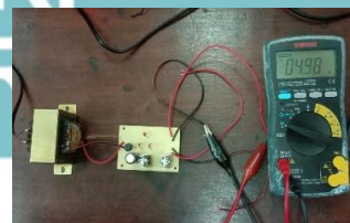
Gambar 10. Pengukuran Catu Daya Dari Keluaran IC Regulator 7805
