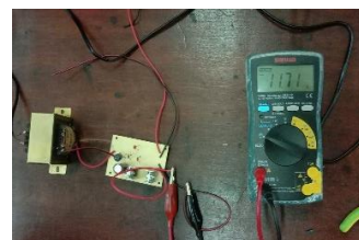
Gambar 11. Pengukuran Catu Daya Dari Keluaran IC Regulator 7812
