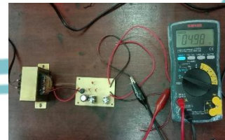
Gambar 10. Pengukuran Catu Daya Dari Keluaran IC Regulator 7805
