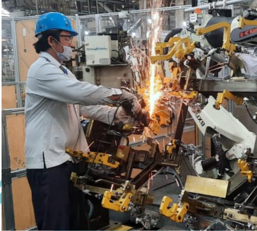
Lampiran 6. Repair pada Rotary Jig
