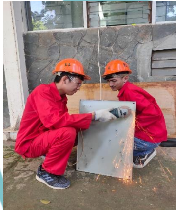
Lampiran 7 Pematangan Baut Pada Base Plate Panel
