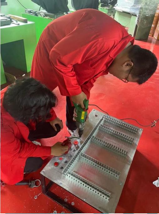
Proses Pelubangan Plat Untuk Tombol
